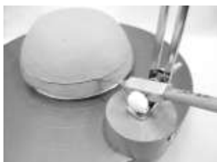
石膏型による成形時に口縁のアタリ(印)をつける
