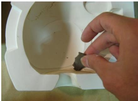
①型の内側が生命線です。型はやわらかいので慎重に取り扱ってください。粘土の汚れを取り除くときは粘土でくっつけて取り除きます。内側をきれいにするにはなるべくスポンジを使わないようにします。
